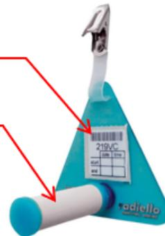
*Support passif équipé d'un tube Radiello ®*
