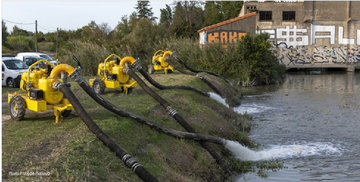
Test des pompes d'évacuation de l'eau
