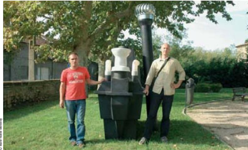
Le bloc doit être à demi enterré, et le WC habillé d'une cabane avec porte
