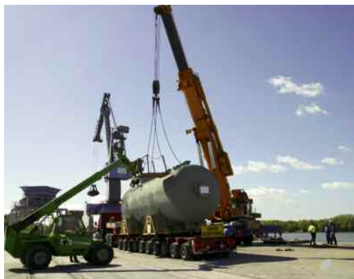
Une pièce de chaudronnerie hors gabarit (12 mètres de long sur 5 de diamètre) fabriquée aux CMP est chargée au port fluvial à destination du sultanat d'Oman dans le golfe Persique.
