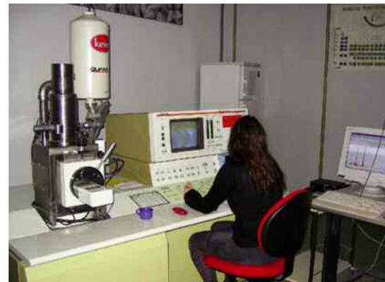
Microscope électronique à balayage pour examiner les échantillons de matériaux
